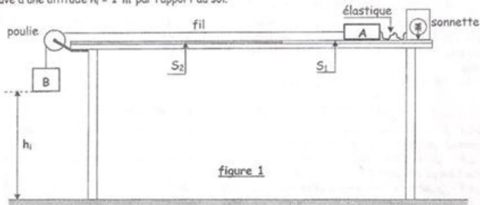
On libère le système. B descend verticalement et A glisse dans un premier temps sur une surface  $S_1$  puis s'apprête à la quitter à un instant  $t_1$  pour poursuivre son mouvement sur une surface  $S_2$  (figure 2). L'élastique est toujours mou.
