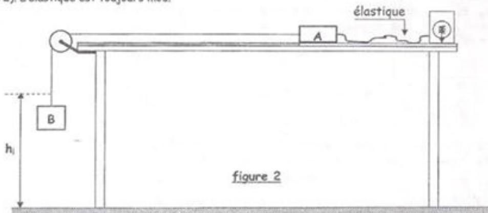
A un instant  $t = t_2$  l'élastique retrouve sa longueur à vide  $l_0$  (figure 3). Par la suite, A va continuer à glisser sur la même surface  $S_2$  et l'élastique va agir sur le système jusqu'à l'arrêt total.
